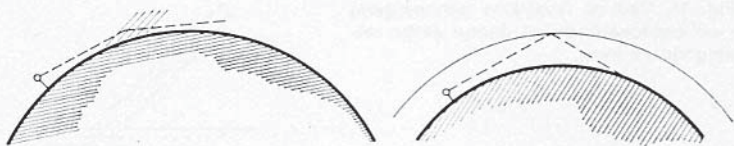
Fig. 14. Tv. Refraktion af UHF-bølgerne gennem fugtig luft gør at udsendelser på kanalerne i UHF visse steder kan opfanges over større afstande end normalt.
