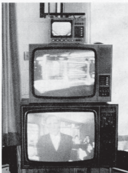
Fig. 10. Forsøgsopstilling for modtagelse. Øverst ses en feltstyrkemåler med billedskærm, dernæst en sort/hvid modtager og nederst en Philips farve-modtager. Bemærk at det er tre forskellige udenlandske programmer, der ses.
