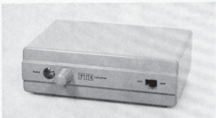
Fig. 59. UHF-converter (Anton Petersen A/S). Strømart 220 volt, strømforbrug 8 mA, forstærkning på ca. 14 dB, ind- og udgang 60 ohm.
